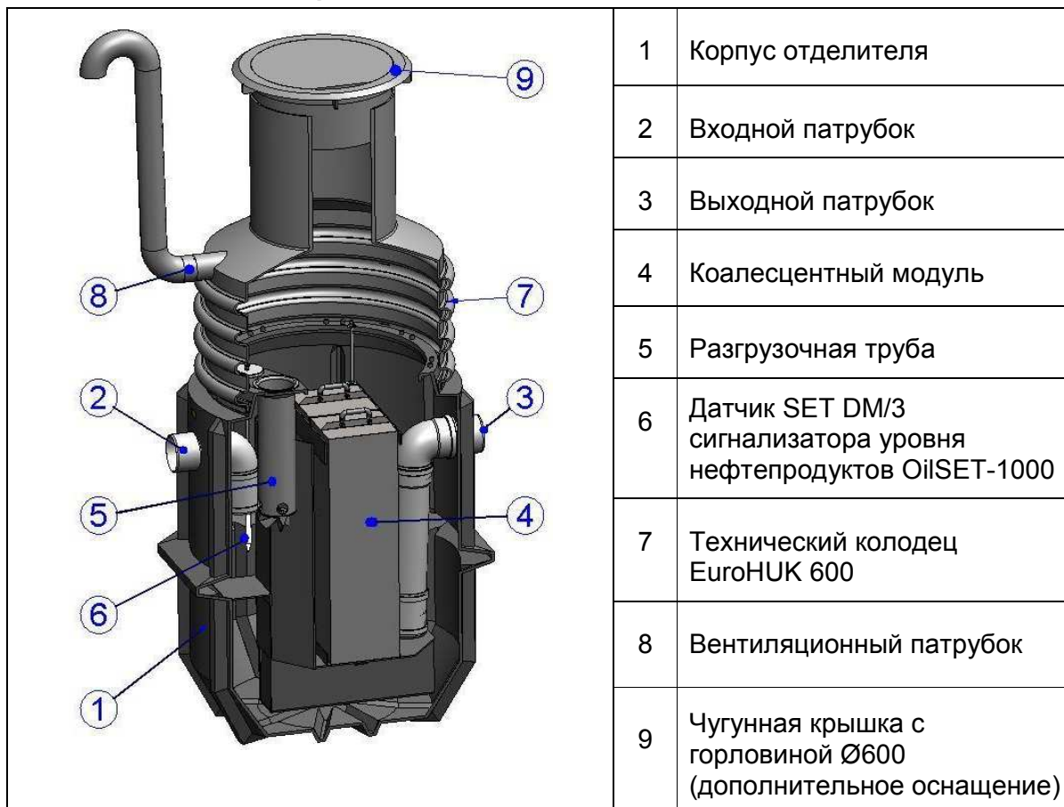
Рис. 1. Комплектация нефтемаслоотделителя.
