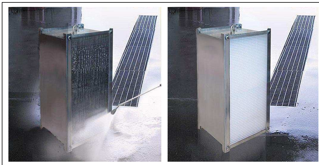
Рис. 7. Коалесцентный модуль до и после очистки.
